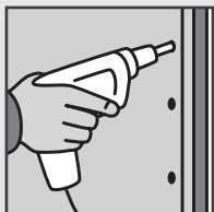
Bild 5: Schrauben auf Stahl-Unter- konstruktion
