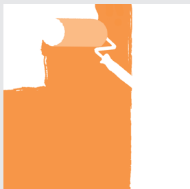
Abb. 3: fermacell Flüssigfolie mit der Rolle 2x vollflächig auftragen (Gesamtdicke mindestens 0,5 mm)
