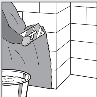
Bild 18: Bei Schornsteinwangen wird die Ansetzbinderschicht auf das Mauerwerk aufgezogen und die fermacell Platte hineingedrückt
